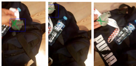
Rysunek 3.7: Algorytm KFC przestaje śledzić obiekt jeśli jego spora część znajdzie się poza widokiem kamery (na ostatnim obrazie nie ma ramki śledzącej obiekt)
