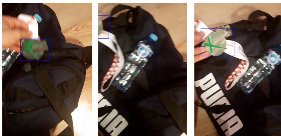
Rysunek 3.9: Algorytm MOOSE nadal z satysfakcjonującą dokładnością śledzi obiekt, który zniknął z obszaru kamery
