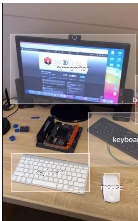
Rysunek 4.2: Przykład detekcji obiektów z poziomu aplikacji uruchomionej na smartfonie z systemem iOS (uruchomionej w trybie Debug- użytkownik końcowy nie widzi (bounding boxów))
