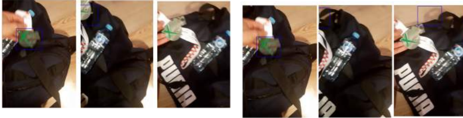
Rysunek 3.7: Algorytm KFC przestaje śledzić obiekt jeśli jego spora część znajdzie się poza widokiem kamery (na ostatnim obrazie nie ma ramki śledzącej obiekt)
