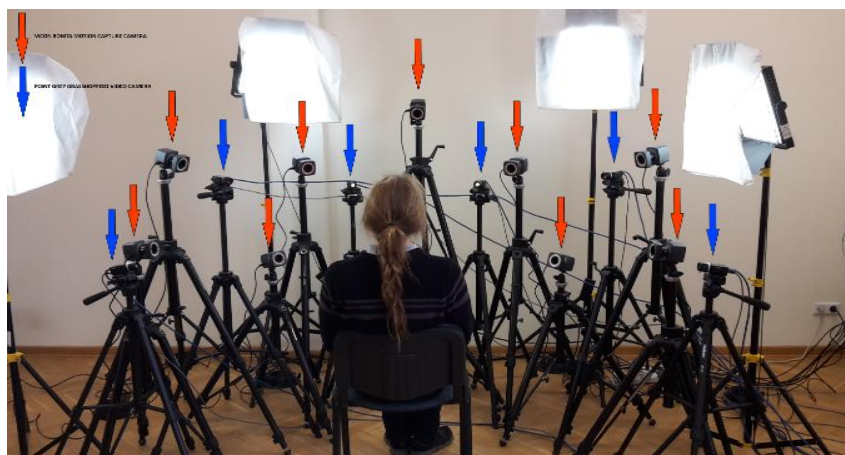
Rysunek 14 Systemy akwizycji obrazu twarzy (markerowy i bezmarkerowy). System 10 kamer Bonita (strzałki czerwone) i 6 synchronizowanych sprzętowo kamer wideo (strzałki niebieskie)
